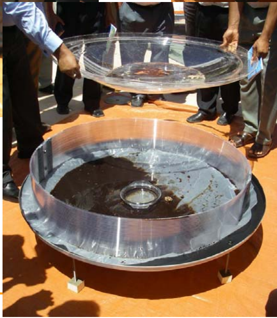
Solution 100% solaire pour le traitement des effluents industriels (comme la margine issue de la production de l'huile d'olive).
